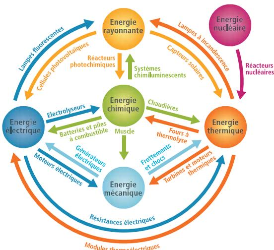
Conversion des six principales formes d'énergie et quelques exemples de convertisseurs.
