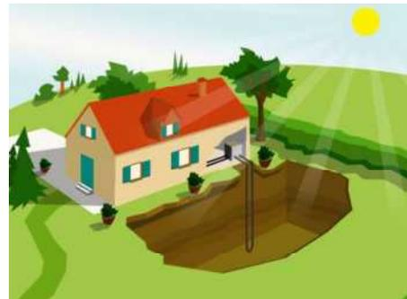
Capteurs enterrés verticalement
