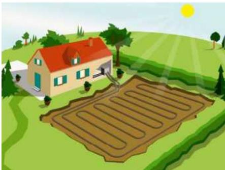
Capteurs enterrés horizontalement
